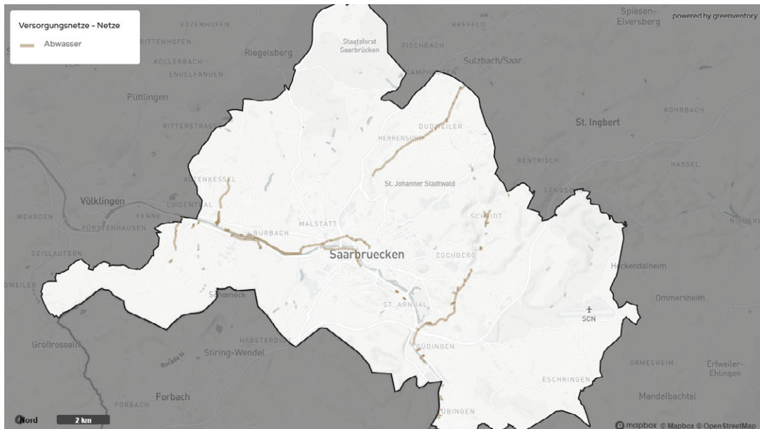
Abbildung 23: Bestehende Abwassernetze (Mindestnennweite DN 800) in Saarbrücken
