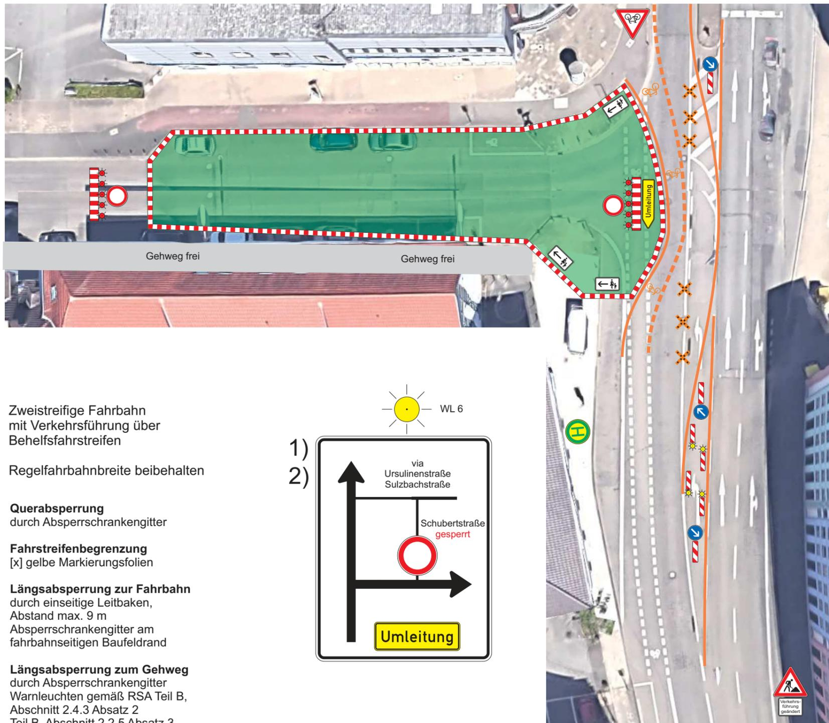
Zweistreifige Fahrbahn mit Verkehrsführung über Behelfsfahstreifen
