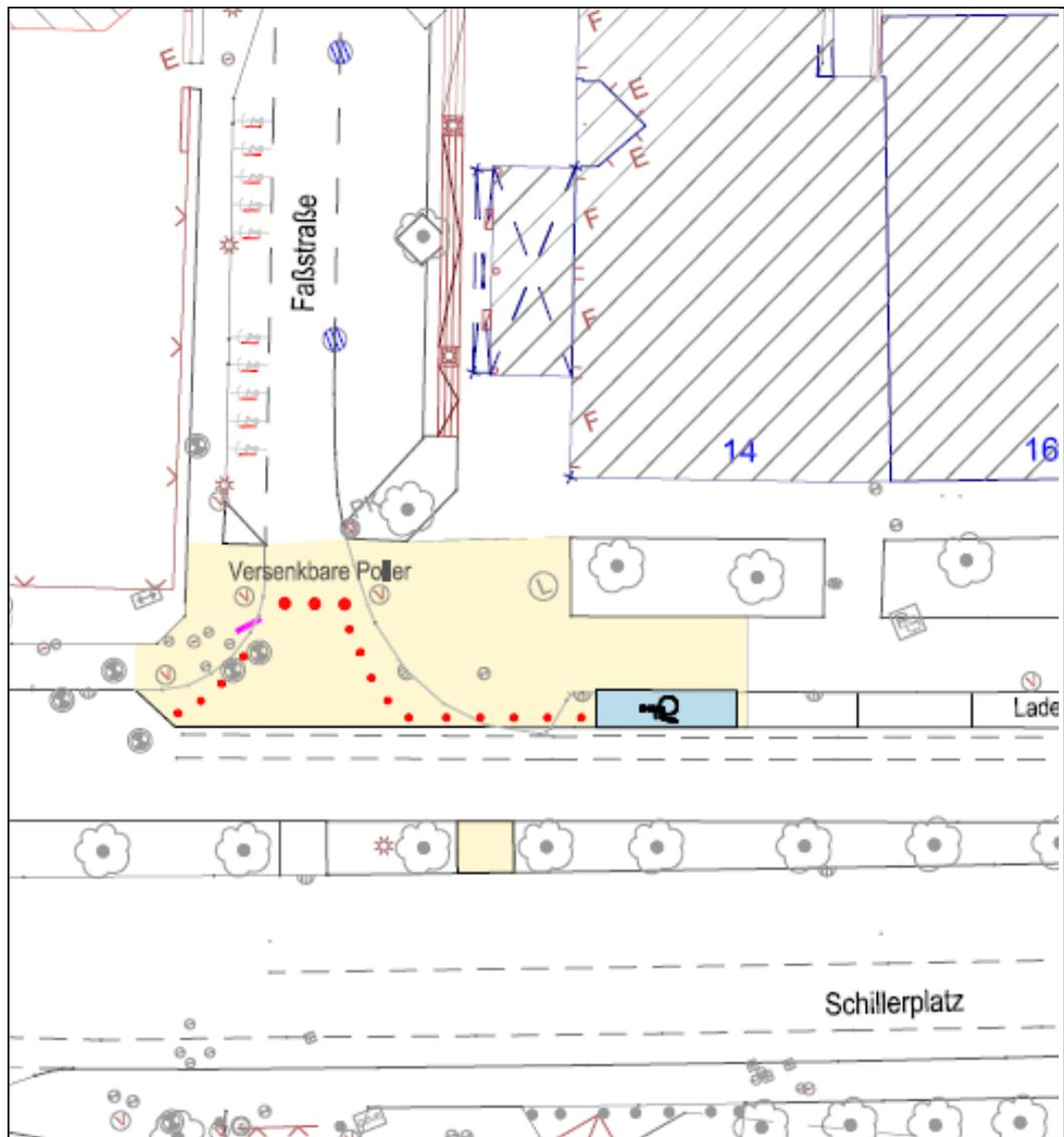
Abbildung 5: Prinzipskizze: Versenkbare Poller Faßstraße/Schillerplatz, ohne Maßstab (LHS Saarbrücken)
