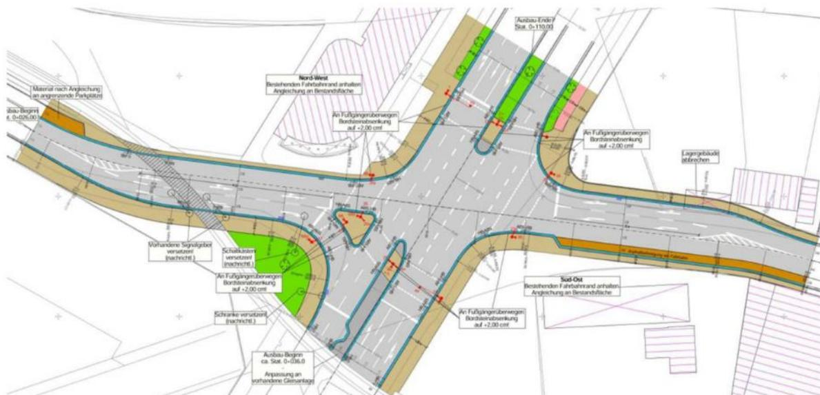
**Abbildung 9: Ausbauzustand der Kreuzung K2**
