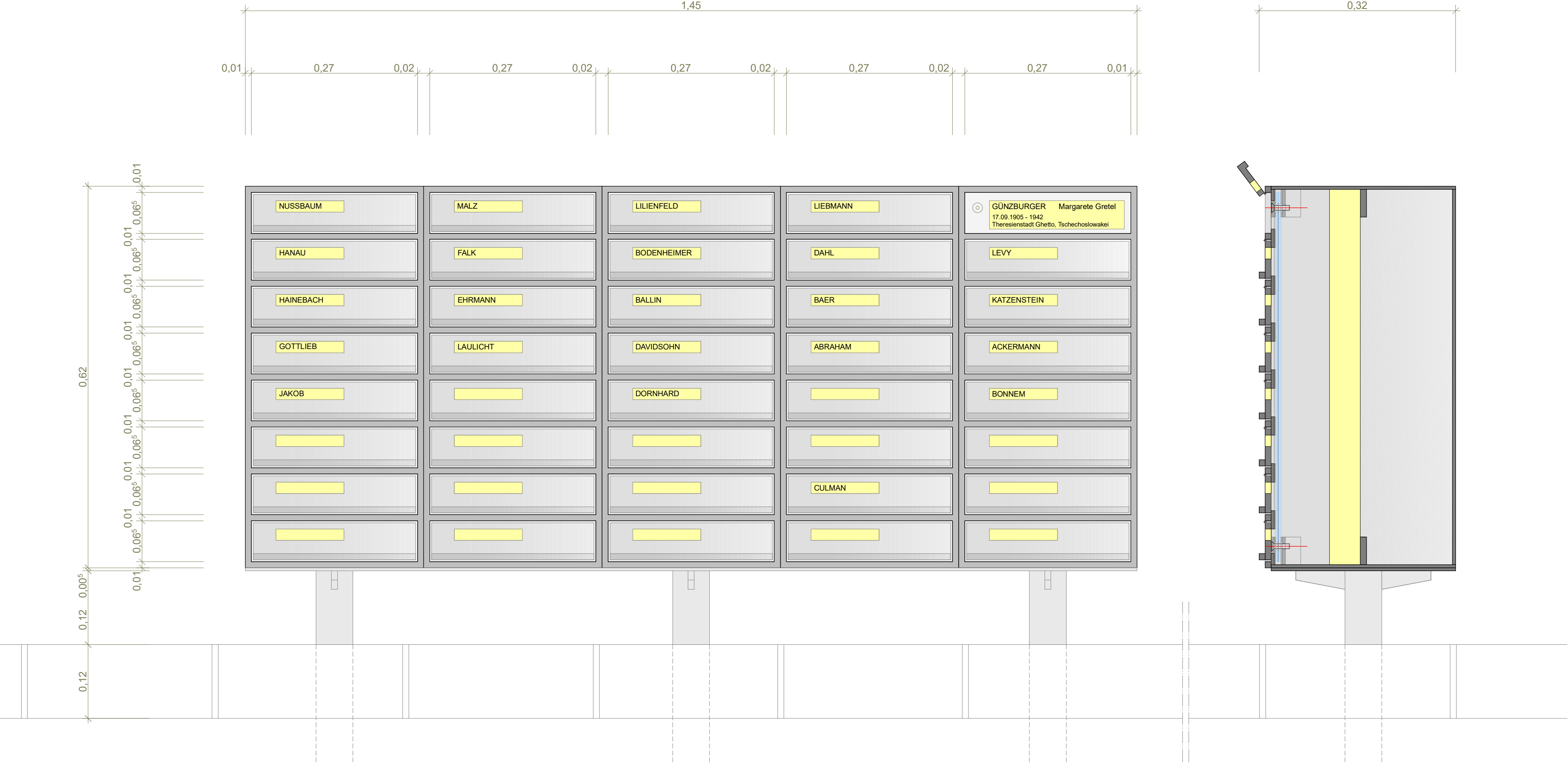
Detail Briefkasten Ansicht/Schnitt M 1:5
