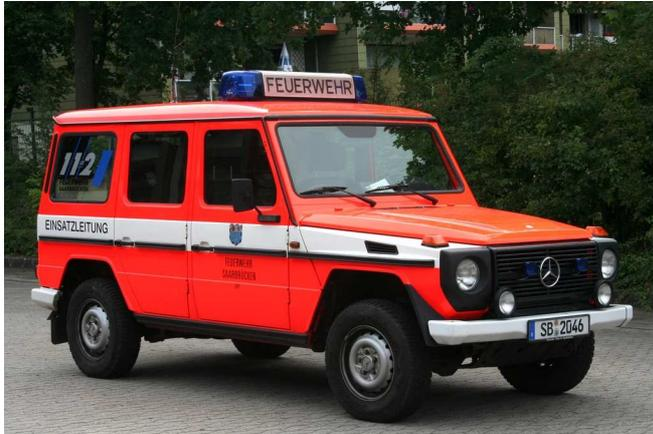
Der ELW 1 dient vorwiegend dem Einsatzleiter - zur Anfahrt und Erkundung von Einsatzstellen - als Hilfsmittel zur Führung von taktischen Einheiten - als Hilfsmittel zum Führen von Verbänden mit Führungsgehilfen, jedoch ohne stabsmäßige Führung
