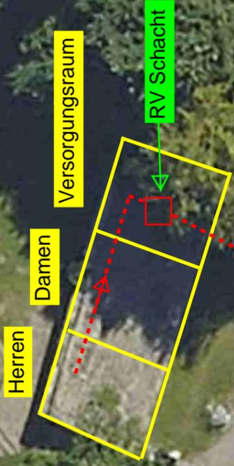
Trennsystemuntersuchung der öffentlichen Toilette am Potato Island. Eingefärbt wurden die Waschbecken in Herren und Damen WC. Farbe jeweils im RV-Schacht im Versorgungsraum sichtbar. Farbe kam im SW Schacht 18446 korrekt an.
